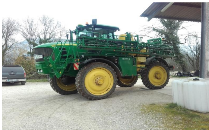
Figure 2 : Pulvérisateur équipé de GPS et station météo embarquée
