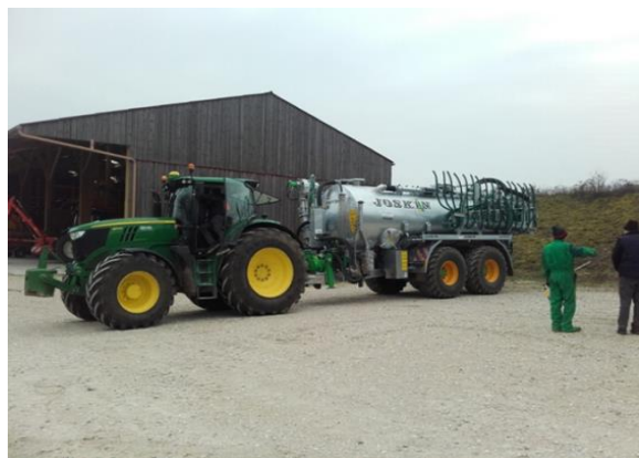
Figure 1 : Troisième et dernière tonne à lisier acquise par la CUMA, connectée au tracteur muni d'un GPS pour une précision optimum d'épandage - C'est un peu notre fil rouge depuis la création de la CUMA. (Caractéristiques : 16000 litres avec ordinateur de gestion d'azote et rampe pendillards de 12 mètres. Tracteur de 170cv)
