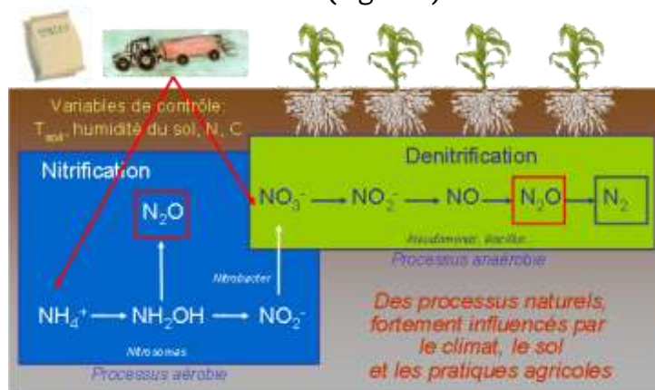
Figure 1 : Chaînes de transformation de l'azote minéral dans le sol conduisant aux émissions de N 2 O (d'après S. Lehuger, communication personnelle).
