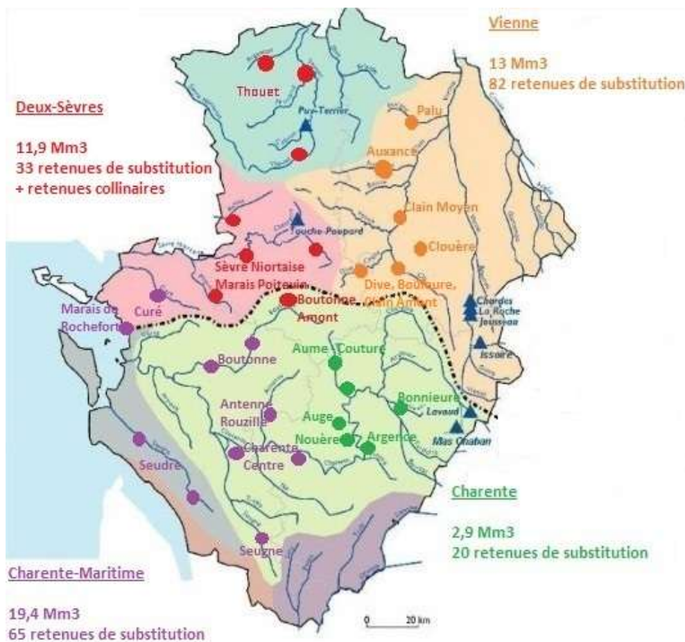
Figure 4 : Positionnement et cubage des différents projets de retenues de substitution en région. Location and volume of the different regional projects of storage reservoirs.
