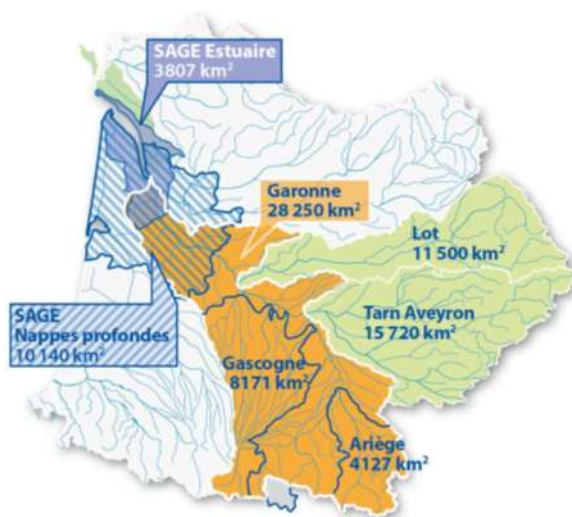
Figure 1 : bassin versant de la Garonne (SAGE : schéma d'aménagement et de gestion des eaux ; zone d'étude de 65 000 km 2 )
