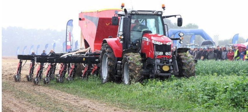
Figure 2 : Semis sous couvert avec un semoir pour semis direct, lors du Salon aux Champs (source:Entraid)
