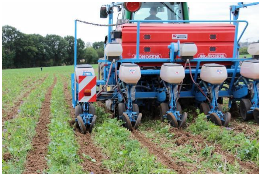
Figure 1 : Semis de maïs dans un couvert végétal avec un semoir monograine classique, après passage au préalable d'un strip-till (source:Entraid)
