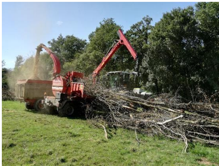
Figure n°2 : Un chantier avec déchiqueteuse de bois en plaquettes projetées dans la remorque (Cuma Terr'eau, Nièvre).
