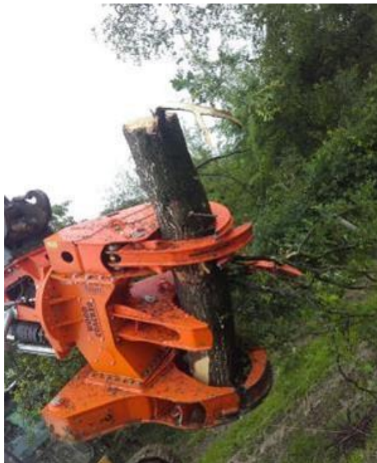
Figure n°1 : Un agroéquipement performant, le grappin-coupeur (Cuma Terr'Eau, Nièvre).
