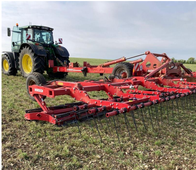
Figure 1 : Destructeur de couvert couplé à une herse à paille Cultro de marque Horsch (Source : Jean-Marc Prud’homme)
