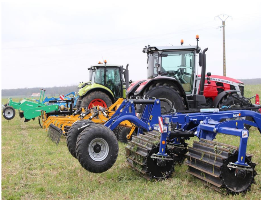
Figure 2 : Rouleaux destructeurs de couverts (Source : Pascal Bordeau - Entraid')
