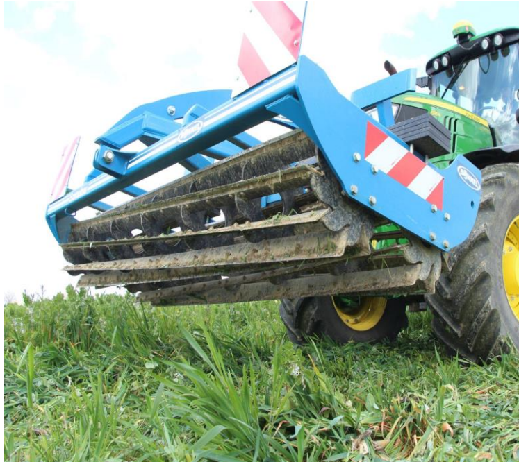
Figure 3 : Rouleau hacheur (Source : Pascal Bordeau - Entraid')
