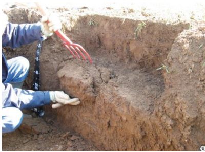
Photo 1 (Inrae) Prélèvement d'échantillon non remanié sur fosse pédologique pour l'estimation de w_{CCtf} et w_{PFPTf} au laboratoire
